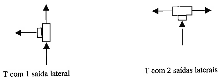
Figura 5.4: Configurações possíveis para entrada e saídas de um T
