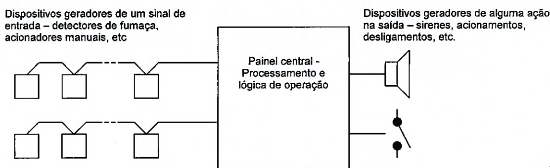
Figura 2.1: Diagrama lógico de um sistema de detecção e alarme de incêndio
